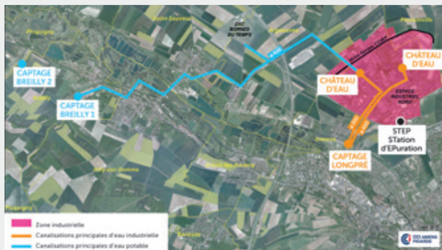
Plan schématique du réseau d'adduction d'eau potable et industrielle
